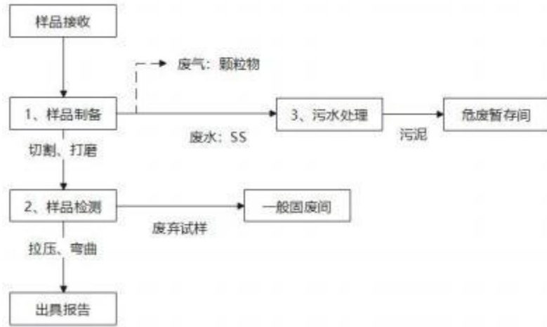
图 1-3 材料力学实验产污节点图
