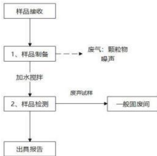
图 1-4 水泥物理性实验产污节点图
