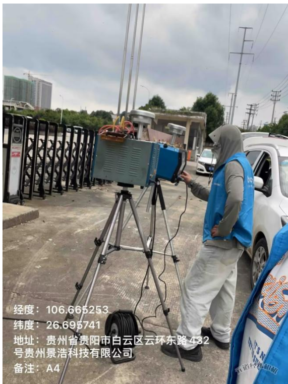
无组织废气采样照片
